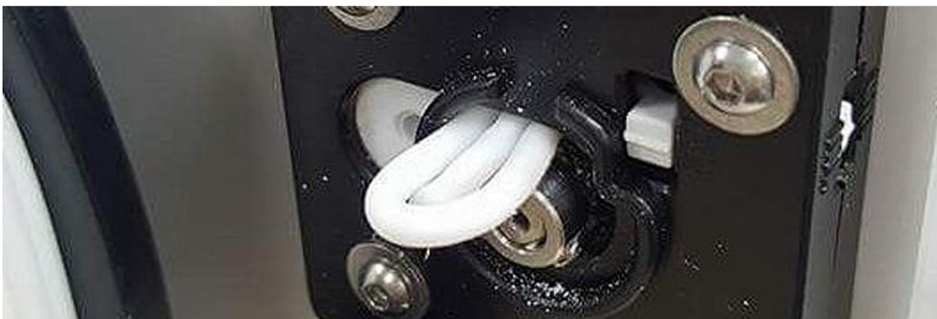
*Un exemple surprenant de ce qui peut mal tourner lorsque vous n'avez pas le bon extrudeur pour l'impression de filaments flexibles.*
