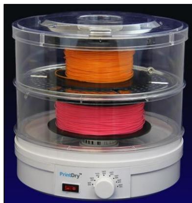
Exemple de séchage de TPU98A dans un "PrintDry filament dryer"
