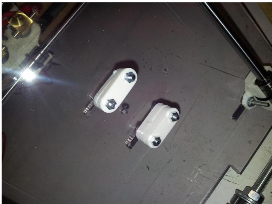
Figure 45 : pour la deuxième partie, mettez le coté lisse vers l'extérieur de façon à bien prendre en sandwich la courroie et éviter les dérapages.
