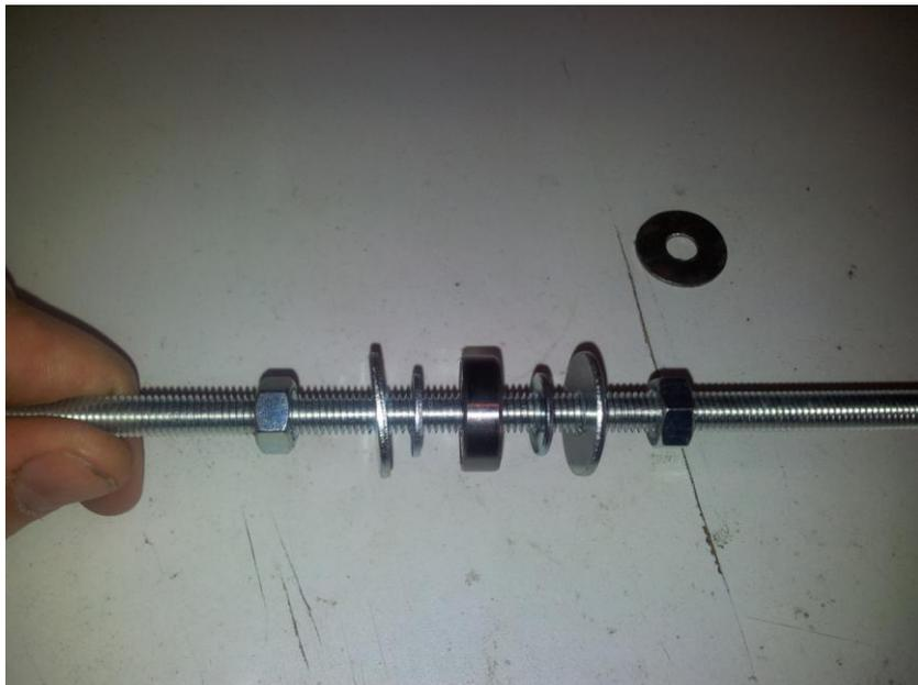
Figure 12 : ajouter le dispositif de poulie
