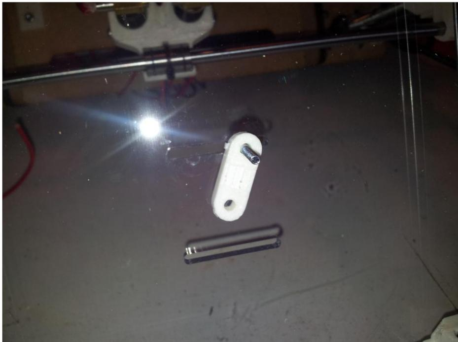
Figure 44 : positionnez les fixations de courroies (belt-clamps) , vous devriez voir un coté different de l'autre, un correspondant à des dents et de l'autre lisse, laissez les dents vers l'exterieur.
