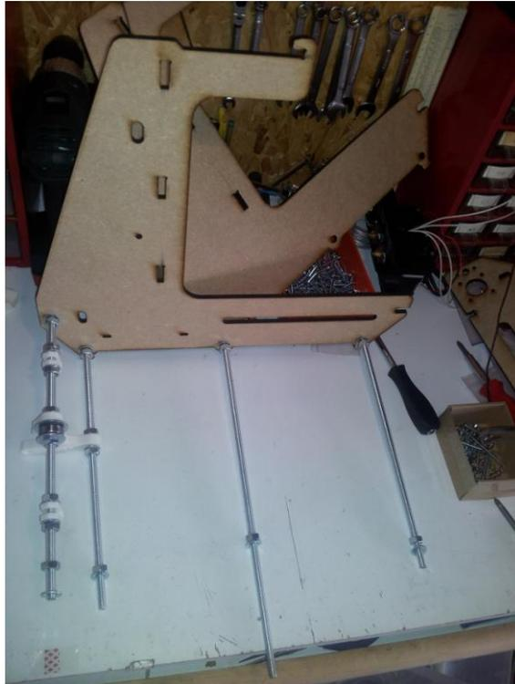
Figure 16 : positionner les parties métallique au cadre
