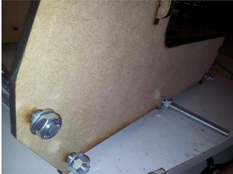
Figure 22 : montez tout les écrous des deux faces (sans serrer)
