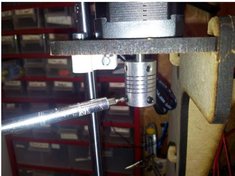
Figure 63 : placez les tiges lisses dans le cadre en bois et aussi dans les roulements que vous venez d'assembler, dévissez ensuite les coupleurs de façon a laisser passer les tiges filetées de support de l'axe X.
