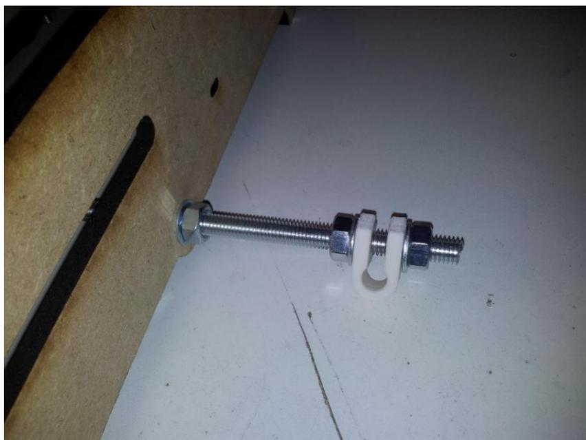
Figure 48 : montez les fixations de barres verticales (sans positionnement ni serrage)
