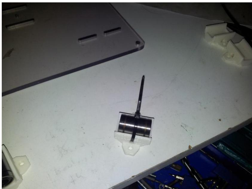
Figure 33 : montez les roulements linéaires LM8UU sur les structures dédiées, ajoutez le collier, serrez correctement et coupez à raz du "nœud".
