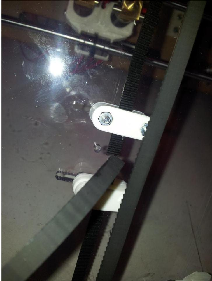
Figure 46: insérer la courroie d'un côté à raz (en serrant à peine) et de l'autre laisser le reste de courroie en faisant le tour des poulies (cette fois ci sans serrer)
