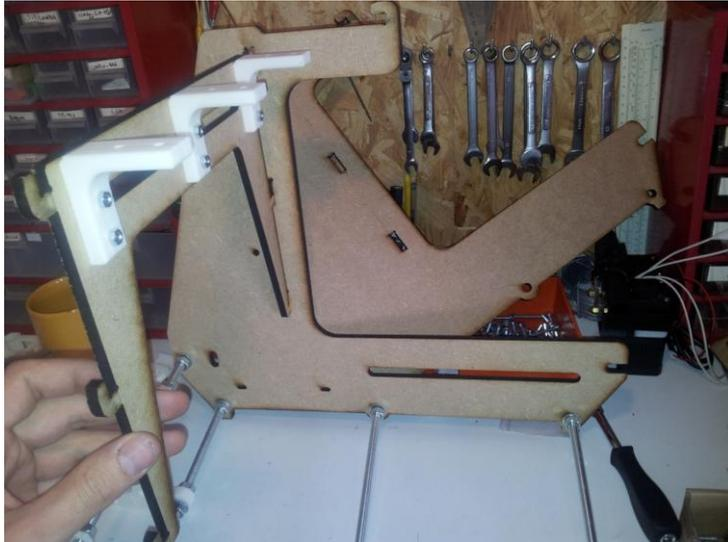
Figure 18 : ajouter le renfort préparé avec ses équerres
