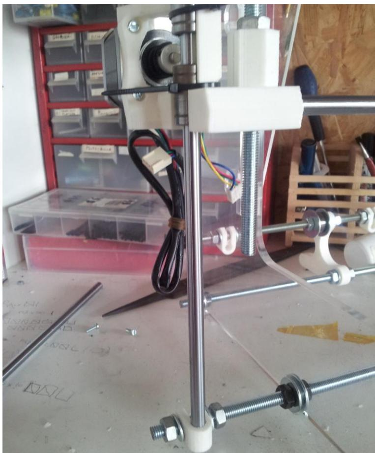
Figure 64 : inserez ensuite les barres de guidages sans laisser dépasser la barre de la pièce plastique et sans rien serrer.
