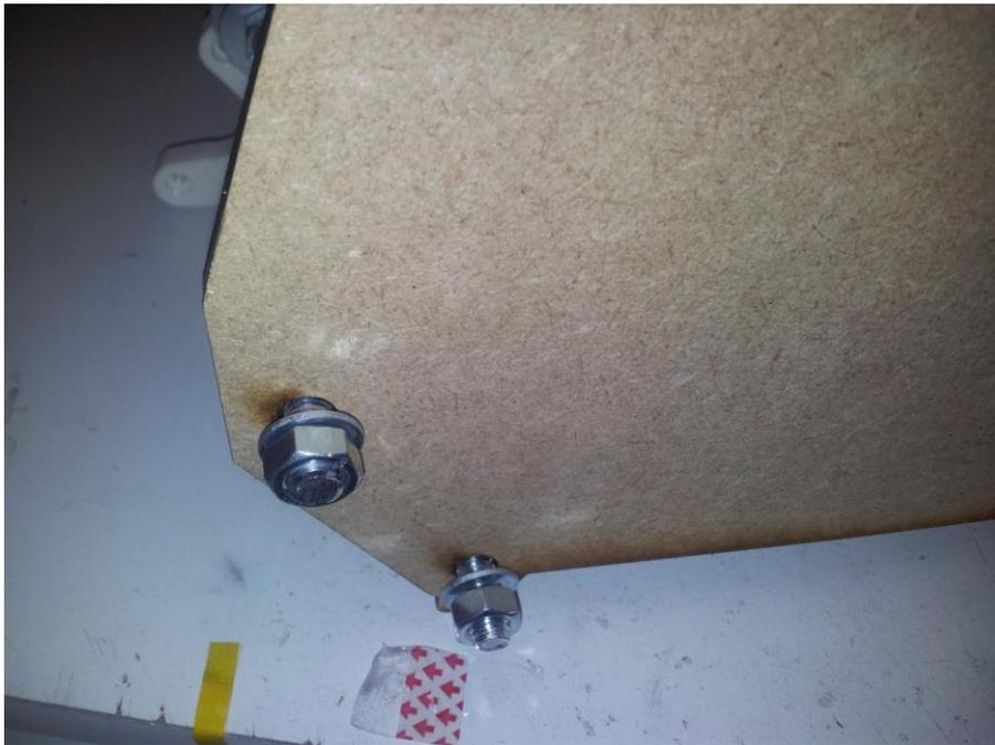
Figure 21 : montez les premiers écrous de fixation du cadre (sans serrer encore un fois)
