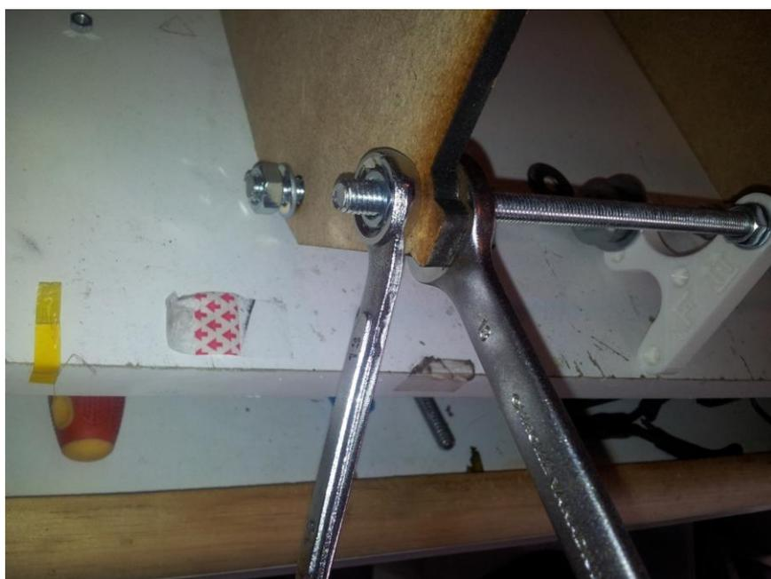
Figure 29 : procédez aux serrages, NOTE! mais d'un seul coté de la structure, cela vous facilitera le montage de régler les écarts de 250mm avec un seul couple d'écrou
