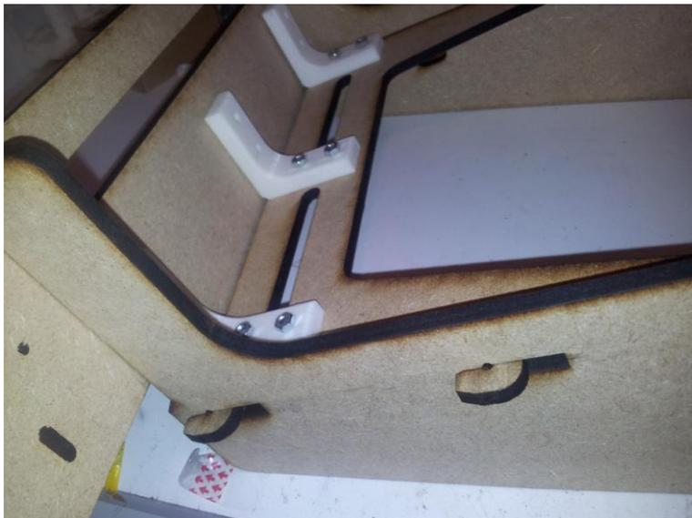
Figure 24: poussez les équerres jusqu'en butée
