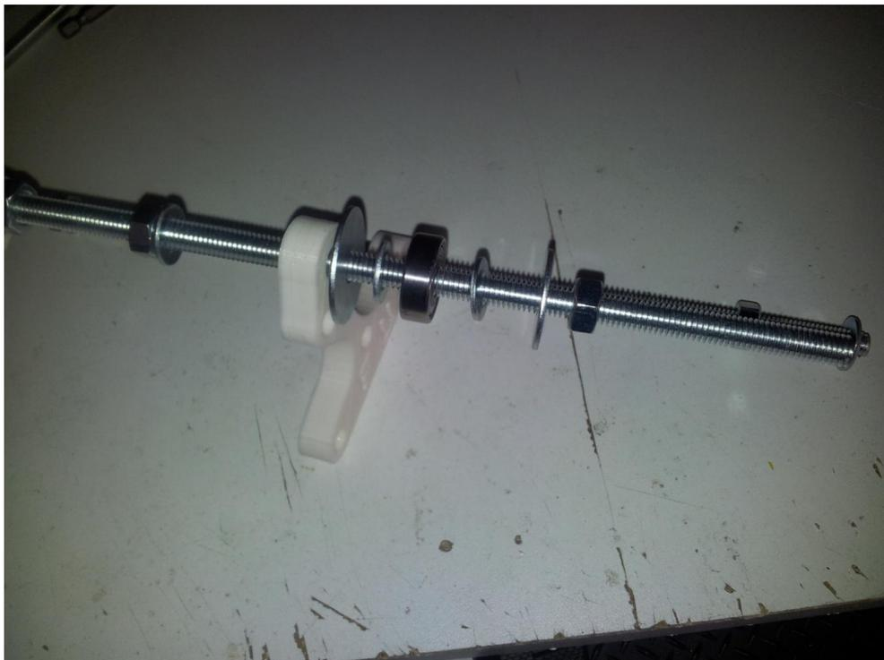
Figure 9 : la positionner sur le Y-bracket en ajoutant le roulement de la poulie d'entrainement
