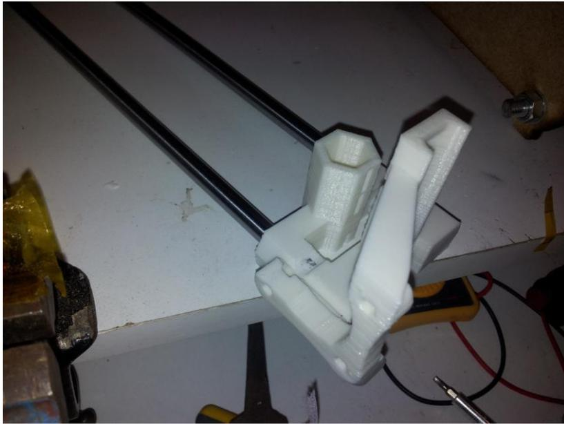
Figure 51 : insérer les barres dans le X motor
