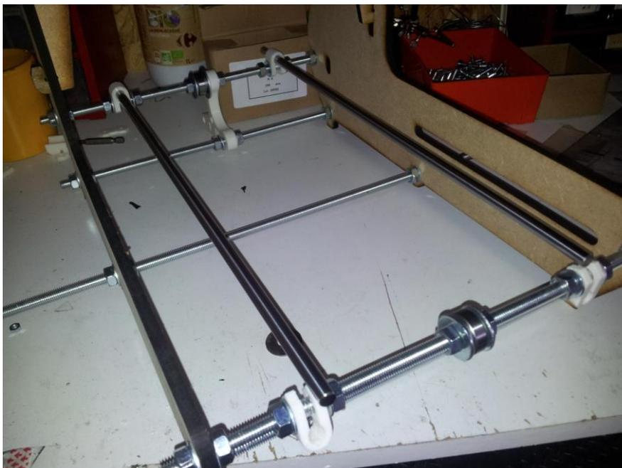
Figure 32 : positionnez 2 tiges lisses (les plus longues) sans serrer dans les accroches dédiées d'un côté et libre de l'autre, l'insertion des barres dans les bloqueurs sont facile si vous avez correctement nettoyé vos pièces plastique au début du tutoriel.
