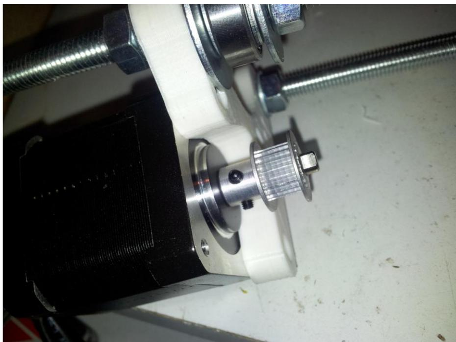
Figure 43 : montez le moteur sur le Y-bracket, en utilisant les petits boulons
