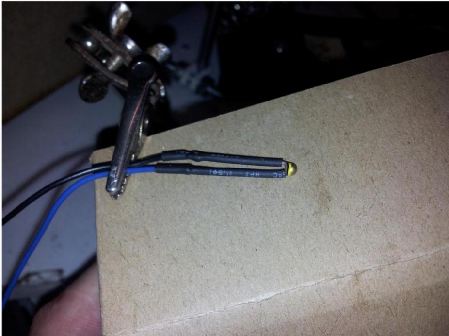
Figure 70 : protégez bien avec de la gaine thermo-rétractable ou du scotch haute température les contacts électriques.
