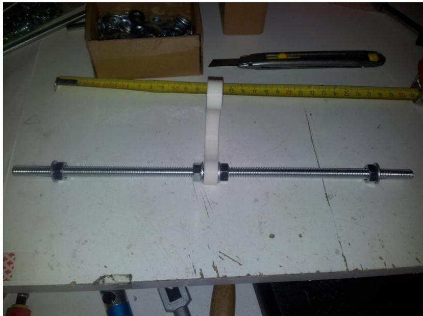
Figure 5 : insérer le y-bracket (destiné au moteur Y) et les écrous/rondelles correspondants
