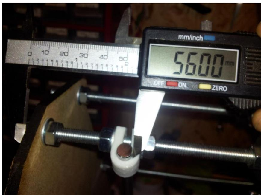
Figure 37 : positionnez à distance égale chaque extrémités des tiges filetées et serrez, la mesure n'est pas obligatoirement celle donnée ci dessus.
