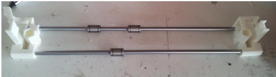
Figure 55 : Ajoutez deux roulements linéaire du coté moteur poulie et un roulement de l'autre
