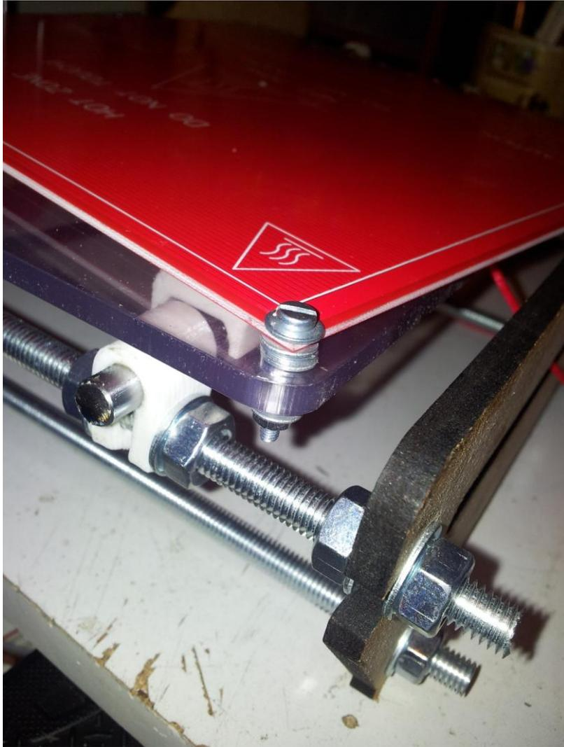
Figure 72 : insérez 3 à 4 rondelles entre le PCB chauffant et la plaque d'acrylique
