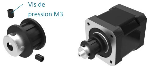
**2** Placer et fixer le moteur NEMA 17 sur la face plane du Y Motor à l'aide de trois vis M3x14 mm et de trois rondelles Ø3 mm. Orienter les câbles d'alimentation vers le bas.
