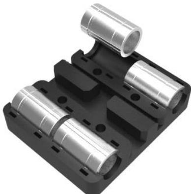
Monter les quatre douilles à billes en force dans leurs logements. Fixer chaque douille avec deux colliers de serrage en plaçant la « tête » du collier à l'opposé de la face plane.
