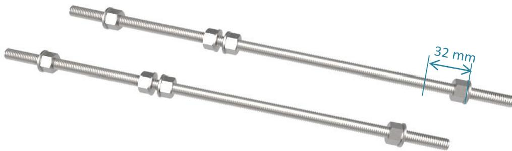
**2** Insérer les deux tiges précédentes dans une partie transversale et fixer le tout à l'aide de deux rondelles  $\varnothing 10$  mm et deux écrous M10. Ne pas serrer tout de suite.
