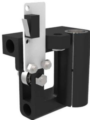
**5** Fixer le endstop sur le X End Idler à l'aide de deux vis M3x14 mm et de deux écrous M3.
