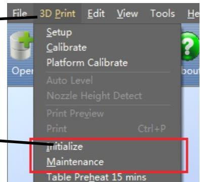
A chaque fois que vous allumez votre machine, l'initialisation est requise. Pendant l'initialisation, la tête et la plateforme d'impression vont se déplacer lentement jusqu'à toucher vos endstop sur les axes X Y et Z. Cette étape of XYZ axes. This is essential as the printer need to find the endpoints of each axis. Only after initialization, the other software options will light up and become available for use.
