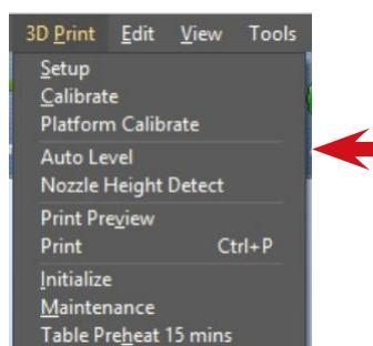
Dans le menu "Impression 3D", sélectionnez "Auto Level" pour lancer le nivelllement automatique. La sonde de nivelllement va alors s'abaisser et commencer à sonder 9 positions sur la plateforme. Les données de nivelllement seront ensuite mises à jour et enregistrées dans votre machine. La sonde se relève ensuite automatiquement.
