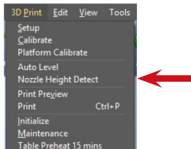
Selectionnez "Nozzle Height Detect" dans le menu "Impression 3D". La tête d'impression va alors se déplacer vers le module de détection de hauteur de buse. Elle va alors toucher et presser la partie métallique sur le module pour effectuer sa mesure.
