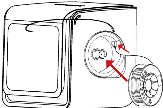
Pour installer la bobine de filament, ouvrez le couvercle magnétique et insérez le filament dans le tube de guidage du support bobine.
