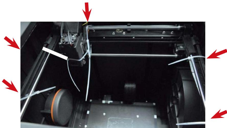
Retirer les colliers de serrage en nylon des tiges lisses horizontales.
