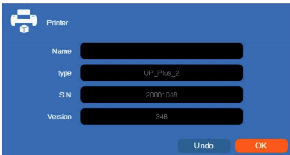
Les infos de l'imprimante s'afficheront en cliquant sur le petit bouton de l'imprimante dans le coin haut gauche de l'icône de connexion de l'imprimante. Une information incluant le type de l'imprimante, le numéro de série et la version de firmware sera affichée. L'utilisateur peut aussi donner un nom à l'imprimante dans le champs « nom ».
