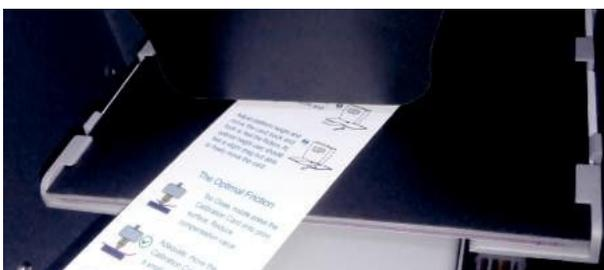
4\ Montez la plateforme jusqu'à ce qu'elle touche juste la buse. Déplacez la carte de calibration entre la buse et la plateforme pour voir s'il y a de la résistance.
